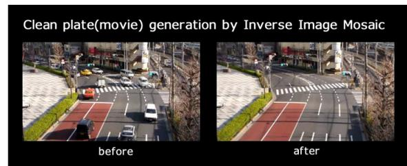
例では、道路を行き交う車を消去しましたが、これを人力で行うと大変な作業となります。逆イメージモザイク法を用いることにより、短時間で生成することが可能となります。
